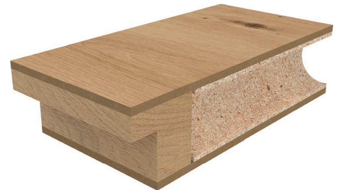
Türblatt mit HPL Oberfläche und sichtbarem Massivholzeinleimer aus Eiche
